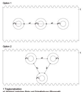
1 Tragkonstruktion a1 Abstand zwischen Rohr und Schottlaibung (Ringspalt) a2 Abstand zwischen den Abschottungen
